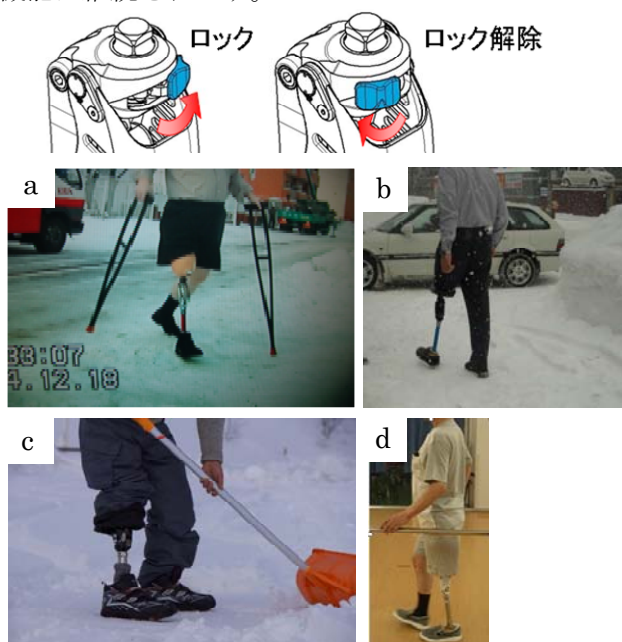
図6 手動ロック機構および使用例
