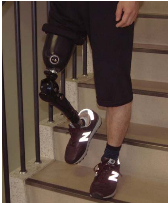
写真2 『ハイブリッドニー』を用いた階段下り
