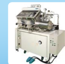
ガス循環精製装置付 グローブボックス
