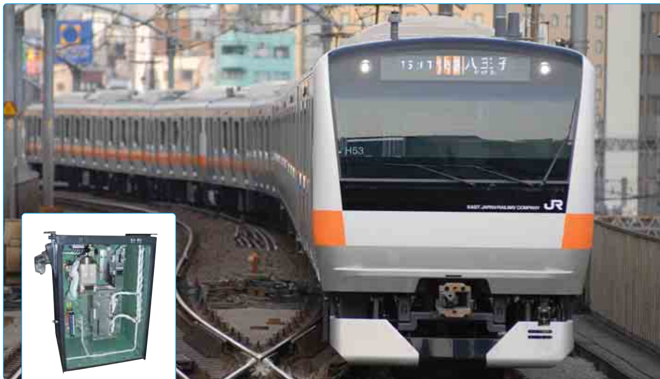
●ブレーキ制御装置
